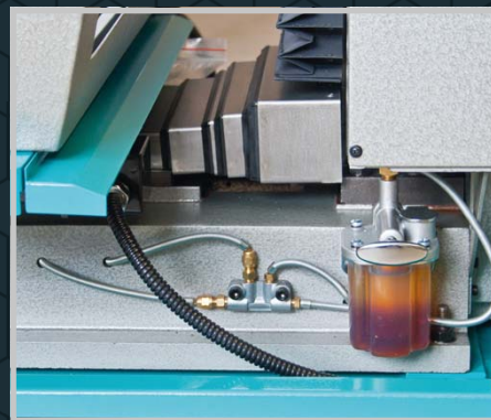
Centrální rozvod mazání
