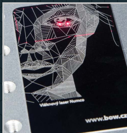
Pomocný laserový paprsek pro projekci a snadné polohování značené grafiky
