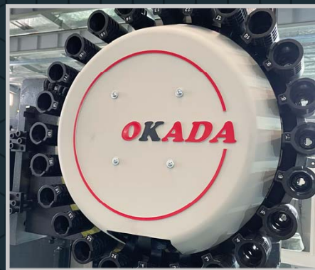
Bubnový zásobník pro 20 nástrojů s dvojitým ramenem.
