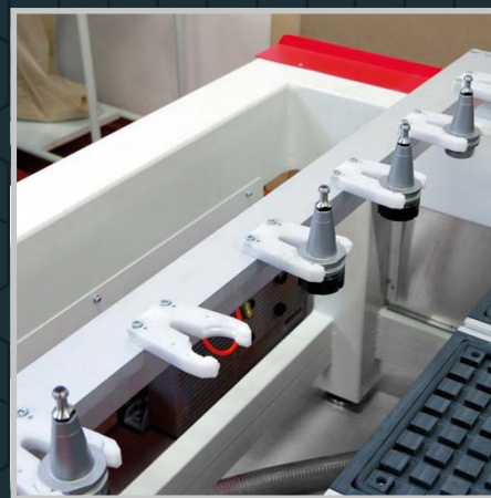
Lineární zásobník na 6 nástrojů, upínací ISO30 (provedení u řady E2)
