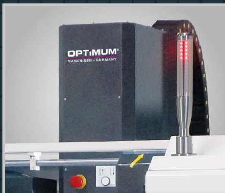
Signalizace provozního stavu
