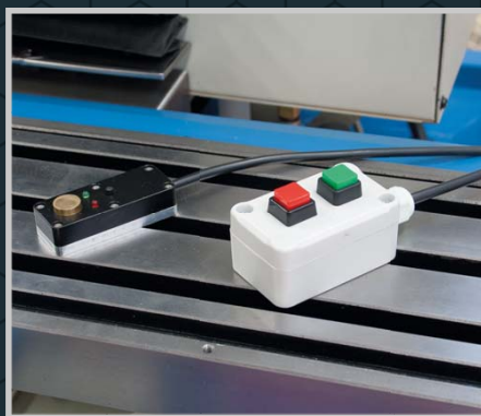
Senzor pro měření délky nástroje / tlačítko START/STOP
