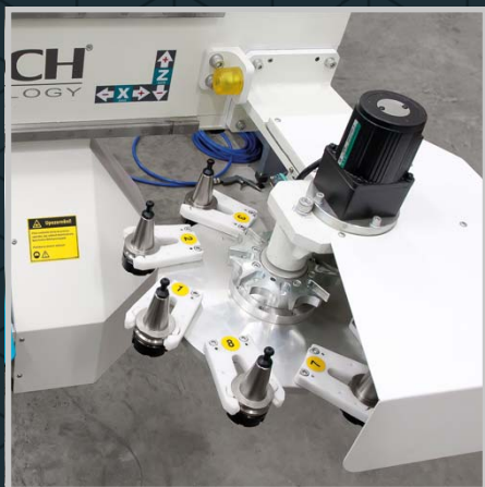
Karuselový zásobník pro 8 nástrojů (provedení u řady E3)
