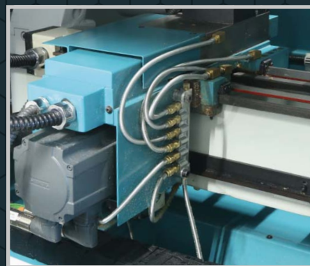
Rozvod centrálního mazání
